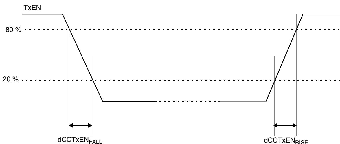
Figure 17. FlexRay TxEN signal
