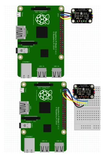
Pi 3V to sensor VIN (red wire)
